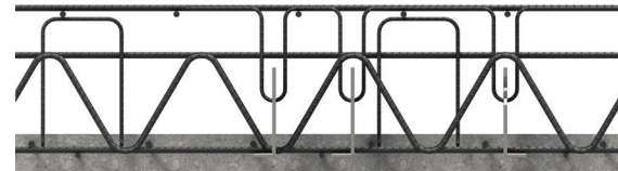
Vollständig bewehrtes Deckenelement vor dem Verfüllen mit Ortbeton
