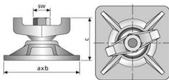
Kugelgelenkplatten, verzinkt. Zum Einsatz bei geneigten Schalungen. Auch kompatibel mit Uni 15.
