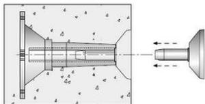
Für einseitige Verankerungen mit BETOMAX® 15, gefertigt aus glasfaserverstärktem Kunststoff.
