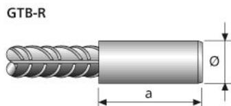
Reduzierverbindung GripTec GTB-R für frei drehbare und längsverschiebliche Anschluss-/ Muffenstäbe mit unterschiedlichen Durchmessern.
