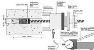
Zum Befestigen von einseitiger Schalung in Beton- oder Felswänden.
