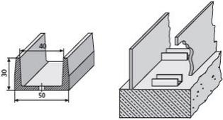
Distanzprofil mit Nagellöchern zum Ausrichten und Ansetzen von Wandschalelementen. Statt Holzlatten, die aufquellen und später verrotten. Um Wasserumlaufigkeit zu vermeiden, Basisleiste nicht über die ganze Breite, sondern versetzt anordnen.
